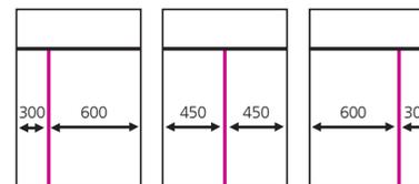
3 positions possibles correspondant à 3 pré-perçages sous la tablette semi-fixe et sur la tablette basse pour fixer le séparateur.
